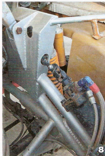
8 Particularité d'un Springbok : son châssis est entièrement tubulaire. Poids plume sur la balance. Grâce à sa caisse en fibres, un Springbok pèse moins de 2 tonnes en ordre de marche.
