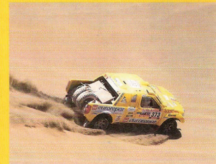
8 Particularité d'un Springbok : son châssis est entièrement tubulaire. Poids plume sur la balance. Grâce à sa caisse en fibres, un Springbok pèse moins de 2 tonnes en ordre de marche.
